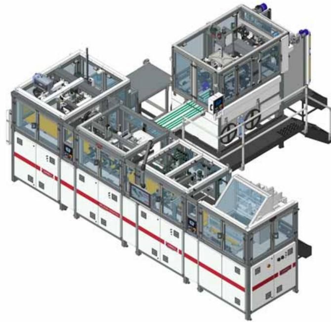
La MC2020 DIGITAL è una linea automatica per la produzione di scatole in cartone rigido teso e microonda rivestire, rivoluzionaria in termini di:
