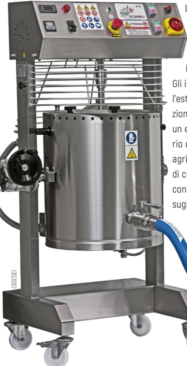
L'abbinamento Cooker-Dosatore automatizza quei processi alimentari che prevedono la preparazione e cottura di prodotti all'interno del cooker ed il conseguente trasferimento nelle confezioni, in condizioni di assoluta igiene e senza l'intervento dell'operatore.
