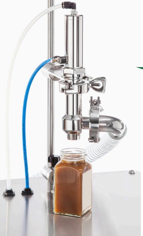
**Dosatori pneumatici** atti a dosare prodotti di vario tipo con consistenze variabili, liquidi, semi densi e densi. La dosatura avviene in modo rapido e preciso grazie a differenti tipi di valvole perfettamente intercambiabili e disponibili in funzione della viscosità del prodotto da dosare:
