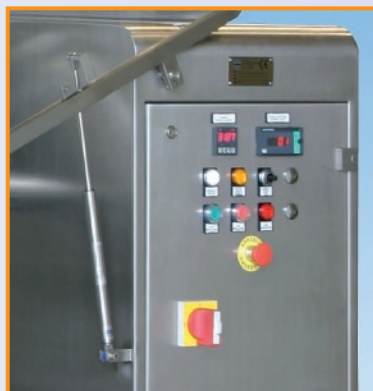
Pannello di comando per macchina a gestione manuale Control panel for manually operated machine
