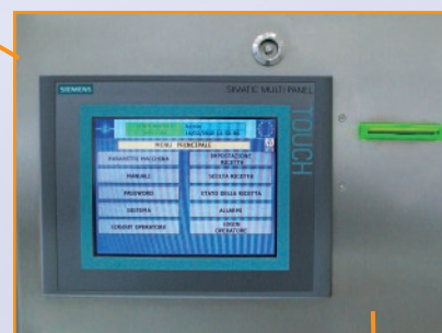
Gestione automatica con memorizzazione ricette Automatic management with recording of recipes
