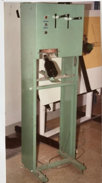
MAQUINA PARA LACRAR BOTELLAS DE CAVA CON LA PRIMERA PALANCA SE DOSIFICA EL LACRE CALENTE, CON LA SEGUNDA PALANCA SE TIENEN EL LACRE CALENTE
