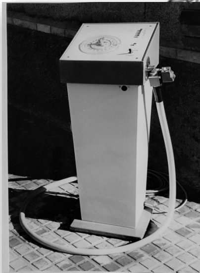
MEDIDOR PARA EL LLENADO DE GARRAFAS SISTEMA POR CONTADOR DE DISCO OSCILANTE Y DETECTOR POR INFRAROJO DE LA AGUA PARA LA PRESELECCION
