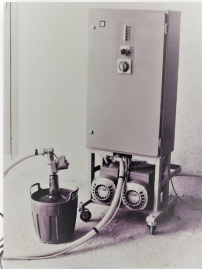
MEDIDOR PARA EL LLENADO DE GARRAFAS SISTEMA POR VASO Y SONDAS PARA LAS DIVERSAS MEDIDAS CON UNA BOMBA PARA EL LLENADO DEL VASO Y UNA BOMBA PARA EL LLENADO DE LA GARRAFA
